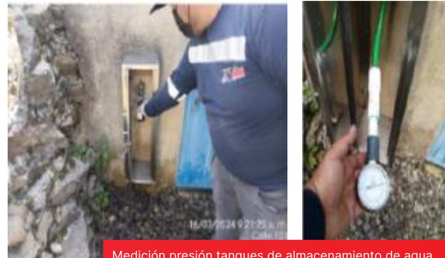
Medición presión tanques de almacenamiento de agua
